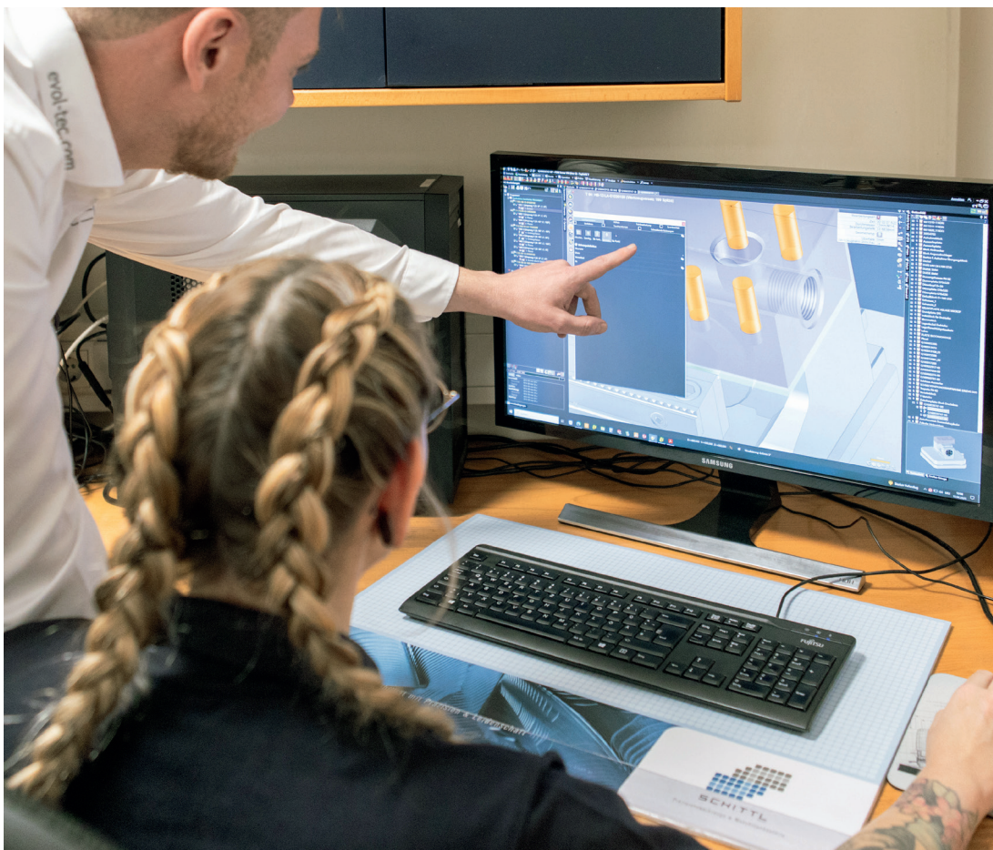
In der Arbeitsvorbereitung wird das Projekt im CAM-System TopSolid besprochen – von der Aufspannung bis zur Werkzeugwahl entsteht der Bearbeitungsplan bei Bedarf auch im Team. Im Bild Leiter AV Daniel Strini (links) und Marcel Leitgeb.
