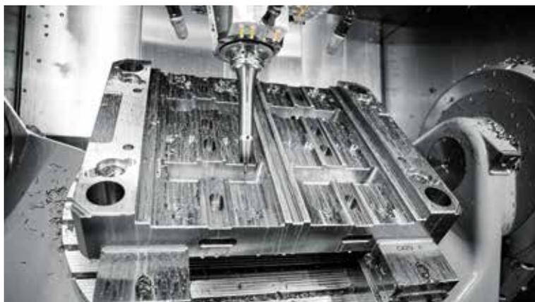
ein Bauteil muss unbedingt vorgezogen werden – wir können mit dem Programm auf jede Maschine ausweichen, weil wir die achsrelevanten Parameter wie Verfahrenswege, Werkzeugwechselpositionen und Minimum-Achsabstand aus der Maschine auslesen und dann diese mit Q-Parameter anfahren“, hebt der Fertigungsleiter die dadurch gewonnene Flexibilität hervor.
