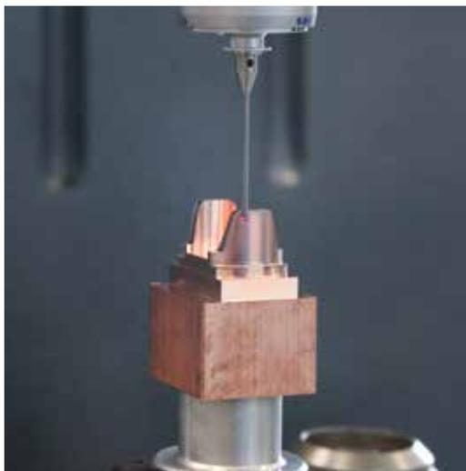
Alle bei Hirschmann Automotive gefertigten **Elektroden sind zu 100 % qualitätsgeprüft**. Über ein von Evoltec entwickeltes Plugin zum Messen bekommt man innerhalb von zwei Minuten einen Soll-Ist-Vergleich.
