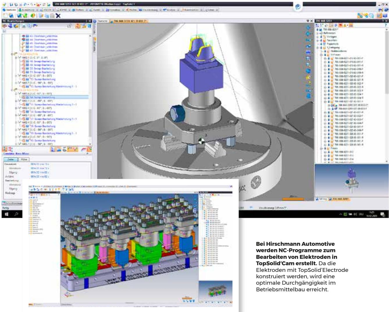
**Bei Hirschmann Automotive werden NC-Programme zum Bearbeiten von Elektroden in TopSolid'Cam erstellt.** Da die Elektroden mit TopSolid'Electrode konstruiert werden, wird eine optimale Durchgängigkeit im Betriebsmittelbau erreicht.
